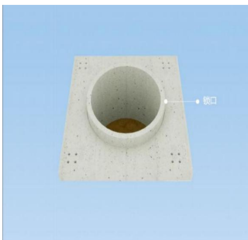
图 7 人工挖孔桩锁口设置高于 30cm
