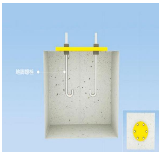
图 8 定柱式旋臂起重机基础采用混凝土浇筑，地脚螺钉应预埋至混凝土基础内
