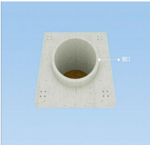
图7 人工挖孔桩锁口设置高于 30cm
