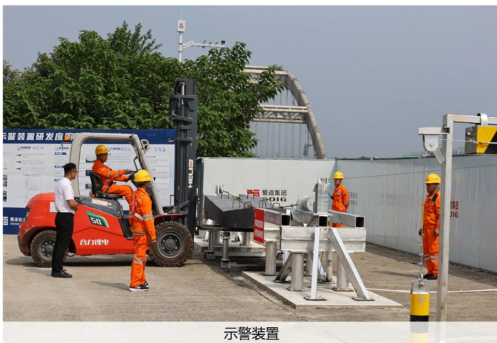
桥梁损毁紧急示警装置
