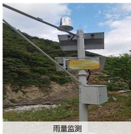
都汶高速、汶马高速泥石流监测预警技术
