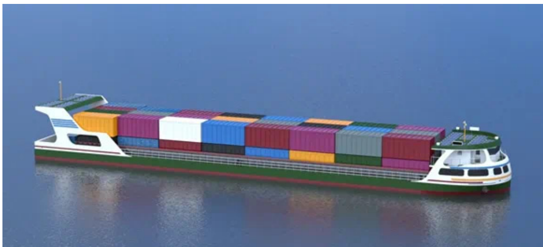
嘉陵江 1100 吨级增程式电动集散货船
