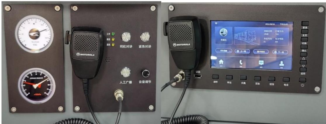
图 7 车载电台和虚拟列车管理系统界面示意
